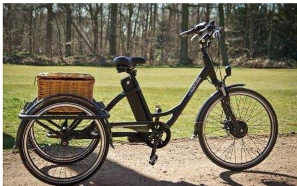
Le tricycle est d'un système de fonctionnement très simple. Un simple bouton On/Off sur le bloc batterie, puis une commande manuelle simpliste pour le réglage de l'assistance. Il est équipé également d'un bouton 'Booster' pour vous aider au démarrage (démarrage en côte par exemple). Le bloc batterie se trouve à l'arrière du tricycle. Il est léger et amovible, vous permettant de recharger aisément à la maison. L'assistance électrique est effectuée sur la roue avant.
